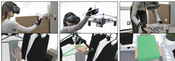
图 11 相遇型被动力触觉装置(Abtahi 等, 2019b)
