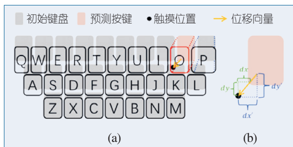
图 2 调整键盘布局的示例。(a) 预测出的最可能输入的键 (“o”) 的位移以及其他键 (例如 “p”) 的缩放。(b) 未经优化的位移向量 ( dx, dy ) 及优化后的位移向量 ( dx', dy' )
